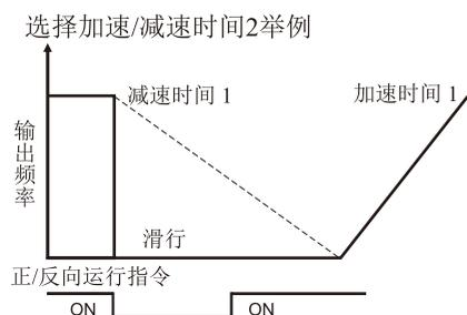
自由运转停止中, 再加入运行指令, 此时交流电机驱动器不动作, 须等超过减速时间后, 交流电机驱动器再以加速时间启动运转, 但是减速时间设定小于最小BB时间内(C04), 在BB时间内运行指令无效。
