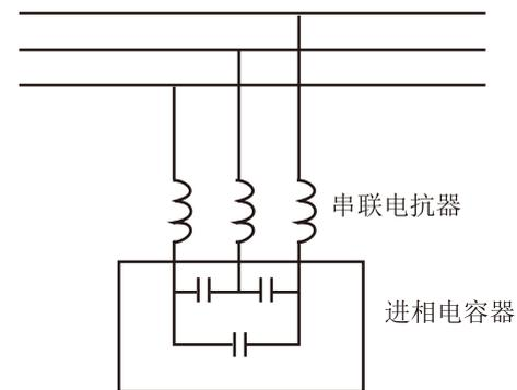
3. 若有进相电容器，则应该串接电抗器以防高谐波电流流入太多引致过热烧损电容器。
