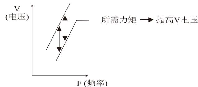
通常不需要调整转矩补偿增益（C12的出厂设定：1.0）。当交流电机驱动器和电动机之间的接线距离较长，或者电动机产生振动时需改变自
