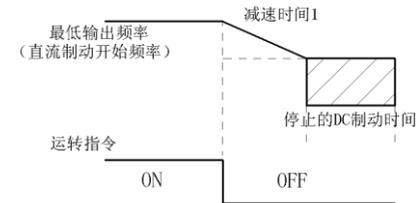
正向/反向运行指令OFF时，电动机以减速时间1（A19）的设定时间减速，而且在停止前立即施加直流制动。如果减速时间短或负载惯性大，在减速时可能会产生过压（OU）故障。在这种情况下，增加减速时间或安装一个可选的制动电阻器（EC5000可以选配）。
