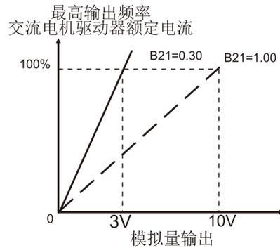
在100%输出频率时设定模拟量输出电压。频率表在0-3V时显示0-50HZ。
