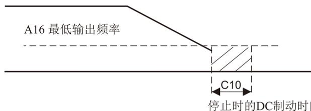
当在停止方式选择（A05）中指定为滑行停止时，则不执行停止时的直流制动。
