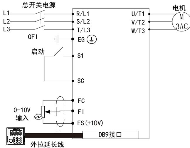
注: SW1-V:0-10V输入时主板的拨码开关拨到V端
