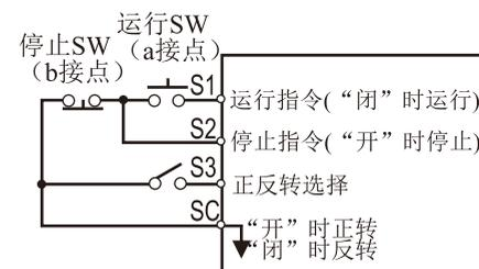
3 线式接线的应用例（设定：1）
