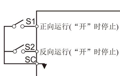
2 线式接线的应用例（设定：0）
