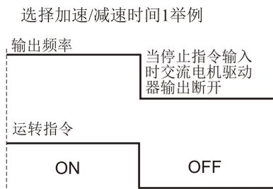
自由运转停止后, 在从接受停止命令开始到减速停止所需要时间之间, 不运行。运转指令接受, 开始运行是在经过减速停止所要时间后, 但是小于C04(最小基极封锁时间)时, 在C04时间内不运行。
