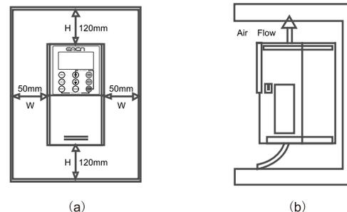
■ 交流电机驱动器应使用螺钉垂直安装，于牢固的结构体上，请勿倒装、斜装或水平安装。
