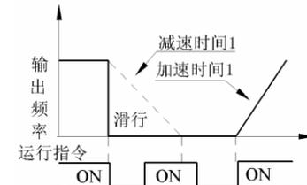
撤消正向（反向）运行指令时电动机开始滑行
