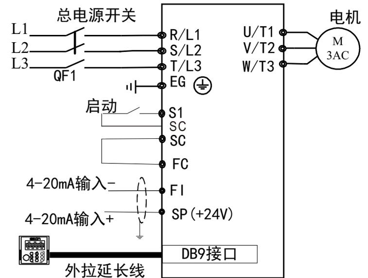
按 **ENTER** 键切换到PID界面，如果PID反馈值为0%，那参数设置错误、漏设或是接线接错端子；如果反馈值在109%，那么反馈信号线位置接错，核实信号线后重新接线。
