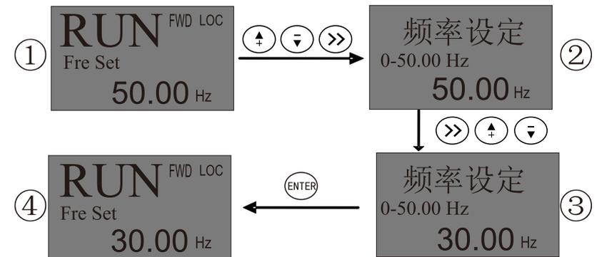
在初始画面①下按 $\uparrow$   $\downarrow$   $\gg$  键进入到频率设定画面②；在频率设定画面②下按 $\gg$  键选择修改位，按 $\uparrow$   $\downarrow$  键设定将频率5改为3如图③所示；设定完频率后按 $\text{ENTER}$  键完成设置，如图④所示。
